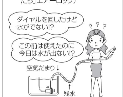
ホース内の水を抜かないで、次回使用時にホース内に残った水が空気だまりを作り水の流れを止め、吸い上げできなくなる。
