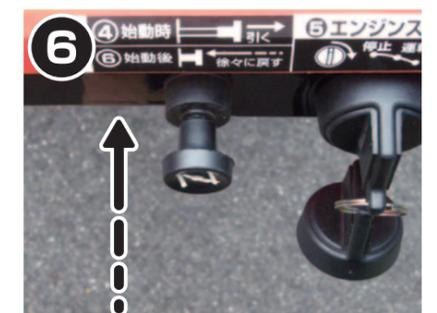
⑥ エンジンが始動したら④のチョークノブを押し込む
