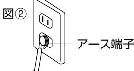
② アースクリップによる取り付けが不安定な時は、アース線からクリップ部を切り取りアース線先端を約30mmむき出してください。(図①参照) その際、芯線を傷つけないようにしてください。折れことがあります。アース線の芯線をコンセントのアース線に巻きつけて、確実に固定してください。(図②参照)
