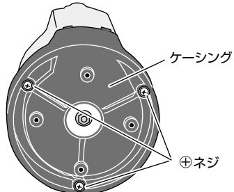
②ケーシング下部の+ネジ3本を外し、ケーシングを外します。
