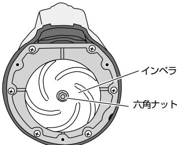
③インペラを手で持ってシャフトに付いている六角ナット(M6)を外します。(ナットを外すと、歯付き座金と平座金が外れます。)
