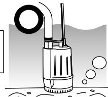
8.ホースを接続する時は、製品付属のカップリングやホースバンドをご使用の上、確実に取付けてください。(ホースの取付方法参照 P.10)
